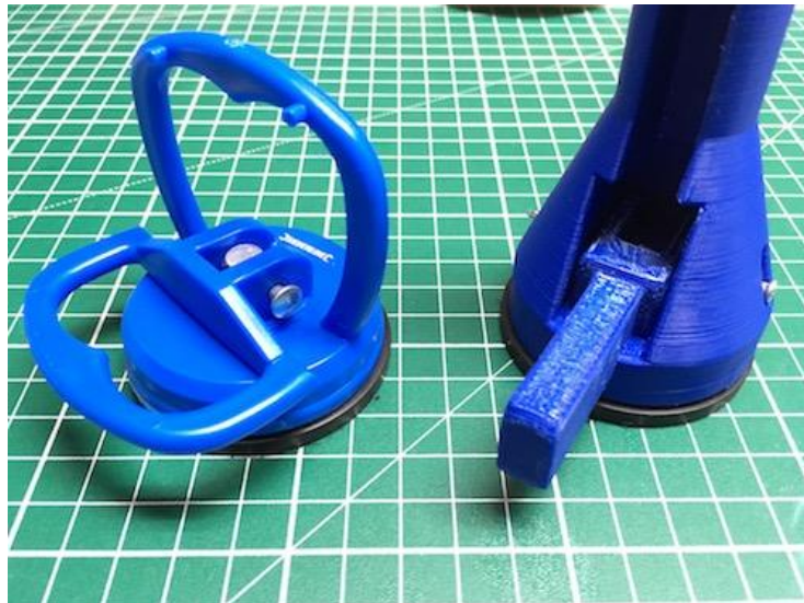
Ambos modelos (original y modificado) en posición liberada. Las ventosas no trabajan, quedando en reposo.
