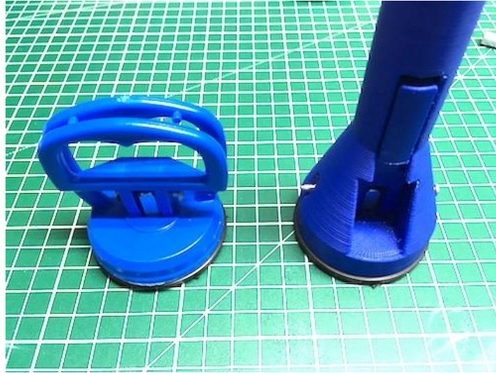
Ventosa original y modificada. En la imagen las ventosas están en tensión y fijadas a la mesa
