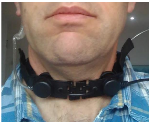
Detalle del micro-auricular situado en el cuello.
